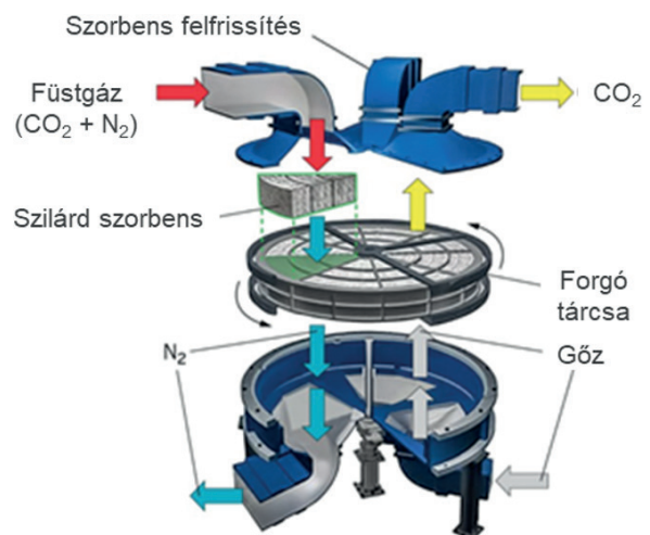
16. ábra A CO 2 fizikai vagy kémiai megkötése szilárd felületen, [146] alapján saját szerkesztés.
